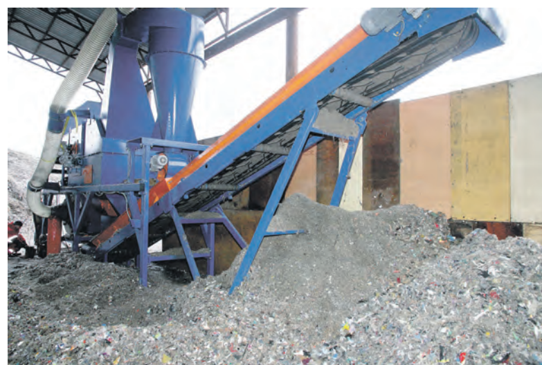
Инженеры-наладчики калужского завода «ЭРГА» тестируют воздушный сепаратор.
