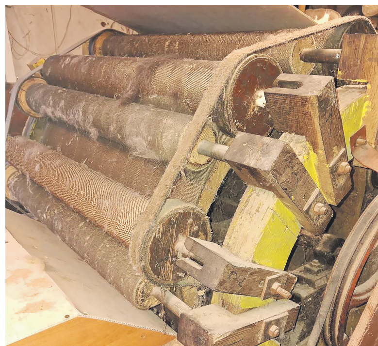
Шерстобойка, при помощи которой изготавливают полотно для будущих валенок.
